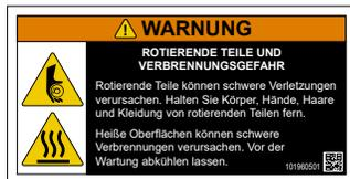
Signalwörter (GEFAHR, WARNUNG, VORSICHT und HINWEIS) und Sicherheitshinweise befinden sich in diesem Handbuch und auf Sicherheitsaufklebern. Lesen und befolgen Sie alle Anweisungen, Sicherheitsvorkehrungen und Sicherheitsaufkleber, bevor Sie das Fahrzeug in Betrieb nehmen.
